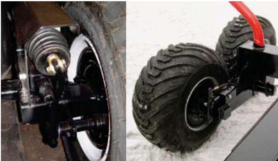
Ein- und Zweiachsbremse - pneumatisch oder hydraulisch
