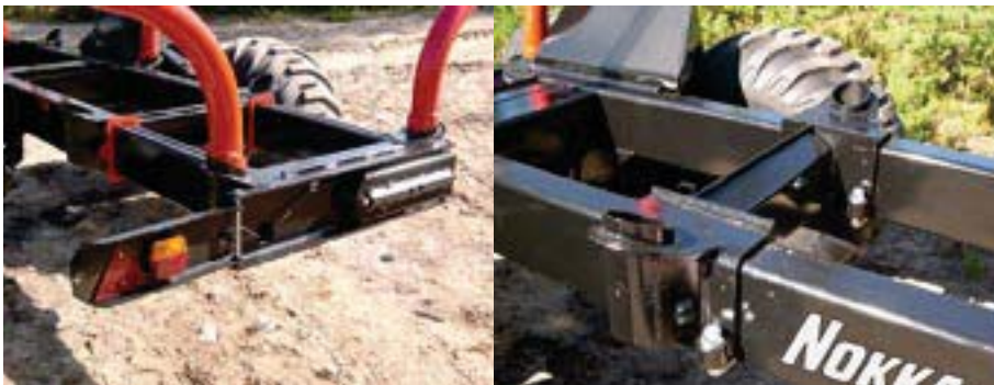
Teleskoprahmenverlängerung, Beleuchtung (92,100-Serie) und Halter für Rungen (100-Serie)
